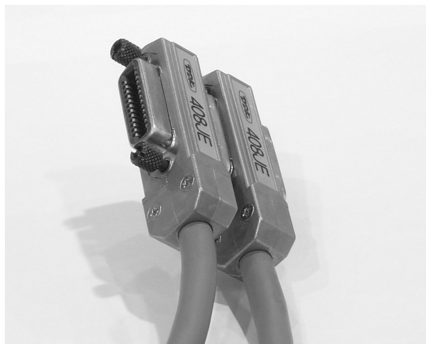
Fig. 9 GPIBコネクタ: 2個のコネクタが接続されている。
